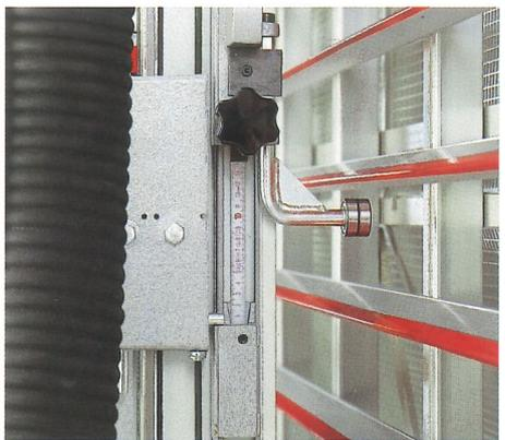
**Streifenanschlag. Einfach, schnell und genau für Wiederholanschnitte**
